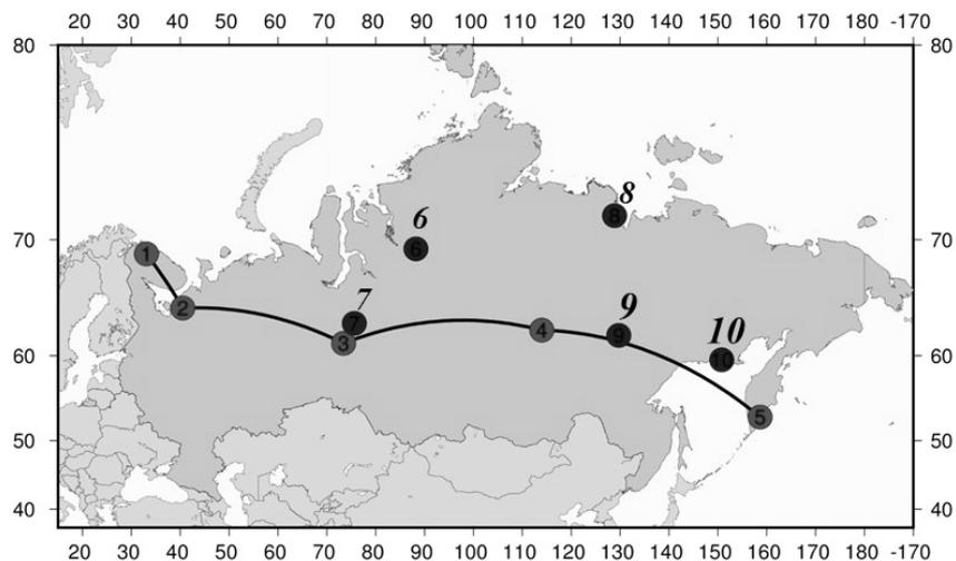
Рис. 1. Схематическое изображение трансконтинентального перелета, вдоль которого выполнен аэрогравиметрический профиль с указанием использовавшихся базовых станций.
