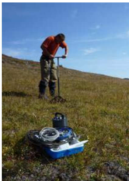
Бурение ручным буром (диаметр сверла 15 см) отверстия в грунте для установки сейсмического датчика. Датчик – на переднем плане.
