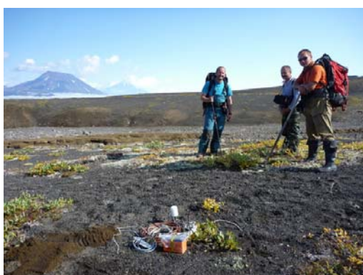
Внешний вид места установки сейсмического датчика при работах по микросейсмическому профилированию. Время записи в точке – 2-3 часа. Датчик помещен в яму и засыпан грунтом. На поверхности – провод, аккумулятор, GPS-антенна.
