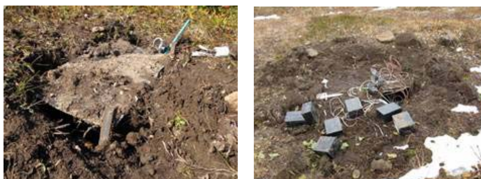
Рис. 3. Временная сейсмическая станция в верховье ручья Игрушка – иллюстрация проблемы организации временных автономных геофизических наблюдений на территории Кроноцкого заповедника. Внешний вид места установки 15.09.2009 и 01.10.2009, после медвежьих «нападений».
