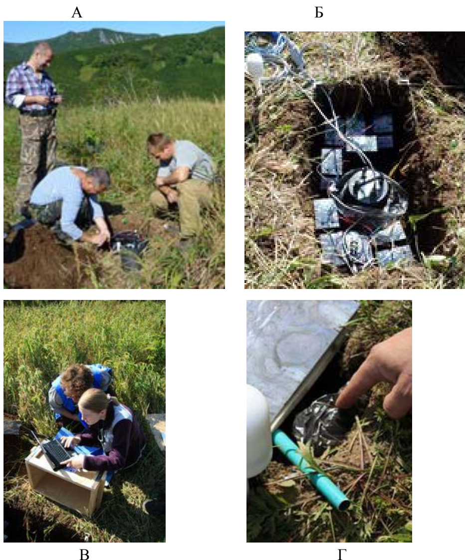
Рис. 2. Временная сейсмическая станция в районе верхней вертолетной площадки на кордоне «Долина Гейзеров» Кроноцкого заповедника. А-В – установка станции. Г – защитная жестко закрепленная металлическая крышка, GPS-антенна, воздуховод для вентиляции блоков электропитания; обеспечен доступ к коммуникационному блоку для снятия данных без вскрытия станции
