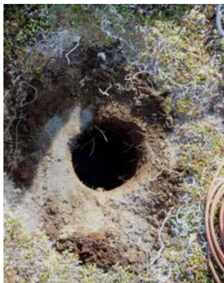
Отверстия в грунте для установки сейсмического датчика, глубина 40-50 см.
