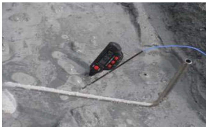
Рис 1. Измерение температуры в грязевом котле на термальном участке «Медвежка» Мутновского геотермального месторождения.
