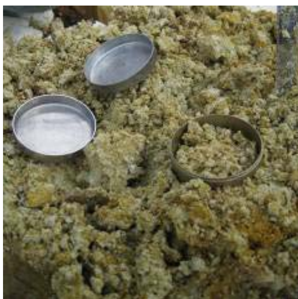
Рис. 15. Отбор глинистых образцов для лабораторного исследования.
