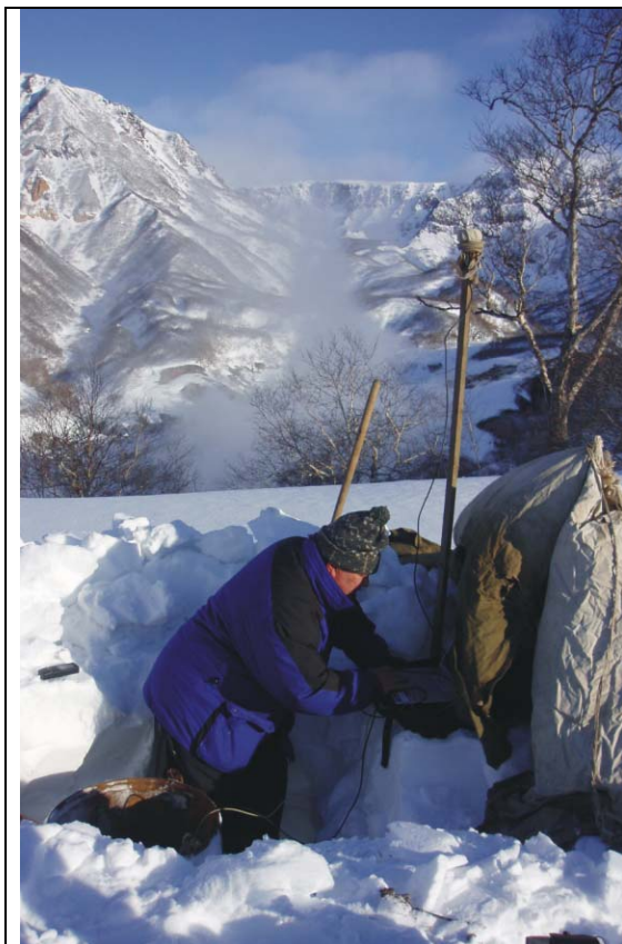
Рис. 2. Установка временной сейсмической станции в Долине Гейзеров. Аппаратура размещена в металлическом корпусе (слева). К цифровому регистратору подключен портативный компьютер для установки параметров регистрации и запуска станции в рабочий режим.
