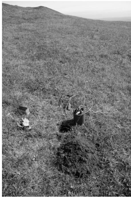
Рис.3. Установка цифровых сейсмометров Guralp CMG-6TD в полевых условиях. Слева: установка для долговременной регистрации. Сейсмометр и батареи помещены в яму, на поверхности остается только GPS-антенна. Справа: подготовка сейсмометра к работе на микросейсмическом профиле. Для установки сейсмометра пробурена яма глубиной 0.5 м с диаметром 15 см. Электропитание осуществляется от портативного аккумулятора.
