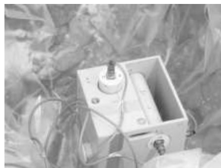
Рис. 4. Индукционный магнитометр для измерений вариаций и микропульсаций геомагнитного и геоэлектрического полей.
