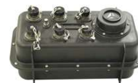
широкополосная сейсмическая станция REF TEK SENS-BBS-120 трехкомпонентный сейсмометр и регистратор (7+3 шт.)
