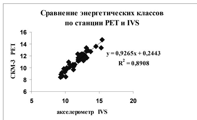
Рис. 4 Сравнение оценок энергетических классов по записям прибором СКМ-3 станции «PET» и акселерометром станции «IVS»
