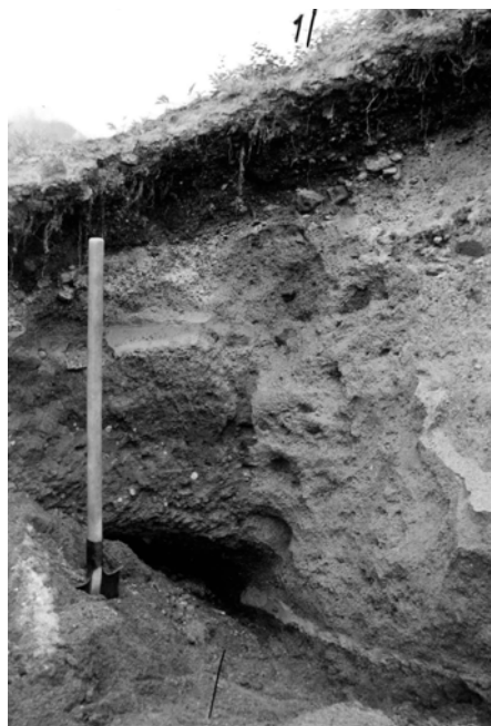
Рис. 5. Северная стенка канавы, вскрывающей плоскость сместителя разрыва VIII. В 1996 г по нему произошла подвижка (взброс) с вертикальным смещением 3-4 см, но в расчистке видно, что несколько тысяч лет назад по этому разлому произошел взброс с амплитудой 92 см. Плоскость сместителя как у старого, так и у нового разрывов падает на запад под углом около 80°.
