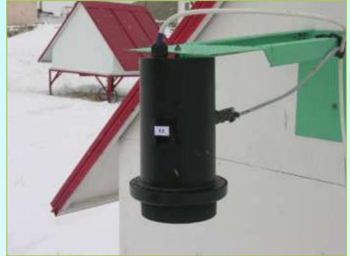
Детектор квазистатического электрического поля, Ez- составляющей, по принципу действия – электростатический флюксометр («field mill»)
