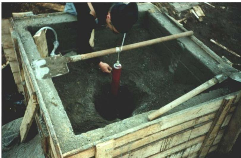
Рис. 2. Установка вертикального датчика магнитометра.
