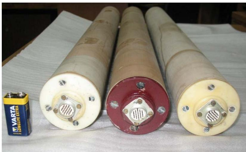
Рис.1 Датчики трех-компонентного индукционного магнитометра.
