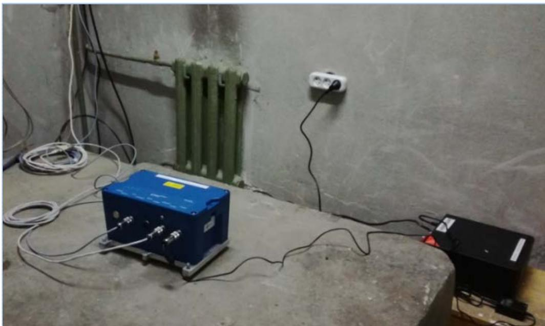
Рис. 3. Измерительная система GMSplus с интегрированным акселерометром AC-73 установленная на пункте СРО «Медео».
