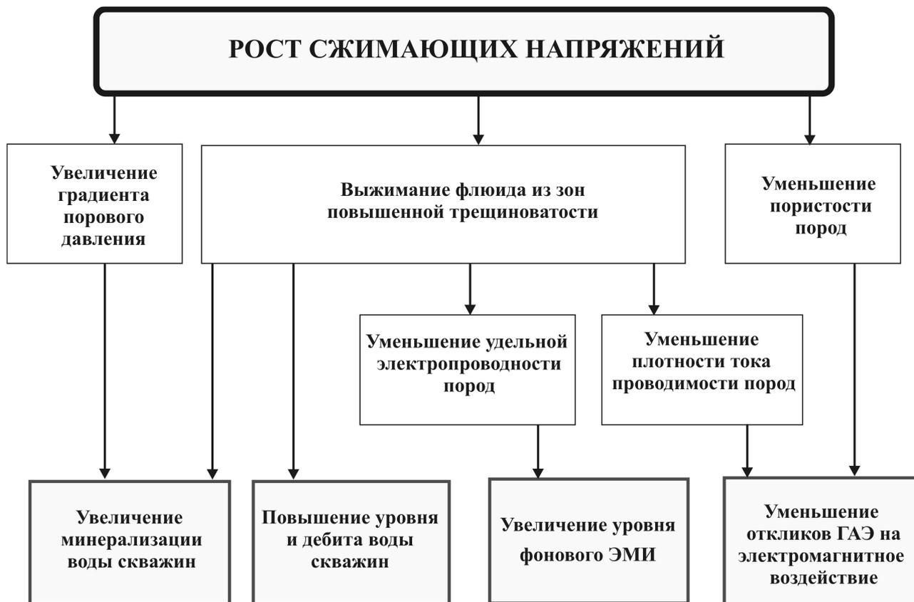
Рис. 2. Тенденции изменений параметров геосреды и откликов ГАЭ на электромагнитное воздействие при росте сжимающих напряжений в районе скважины.
